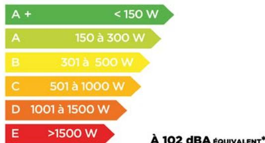
\*La valeur donnée représente la puissance électrique consommée par l'enceinte pour reproduire sur sa bande de fréquence un niveau sonore équivalent de 102 dBA avec un bruit rose. Pour le calcul l'enceinte est considérée comme faisant partie d'un système égalisé ayant une réponse en fréquence absolument plate de 20Hz à 20kHz.
